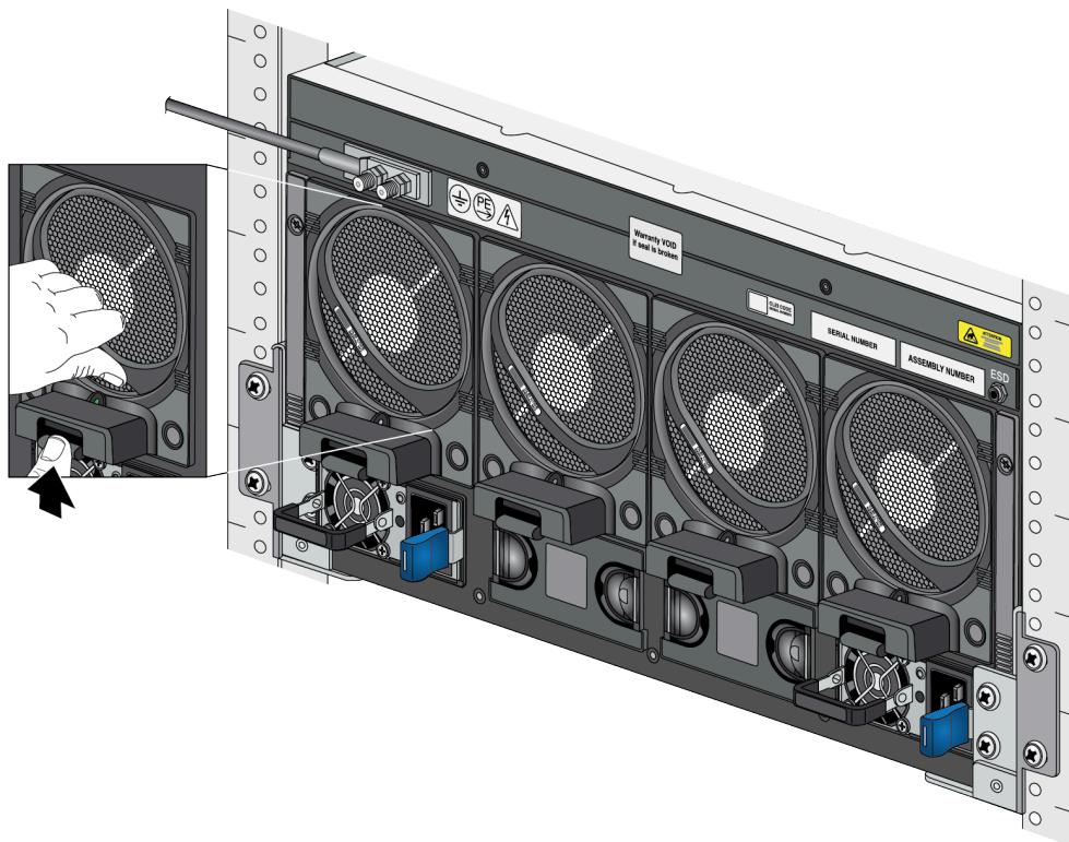
**STEP 5 |** Mientras sujetá el asa del conjunto del ventilador, extraiga con cuidado el conjunto del ventilador de su ranura.
